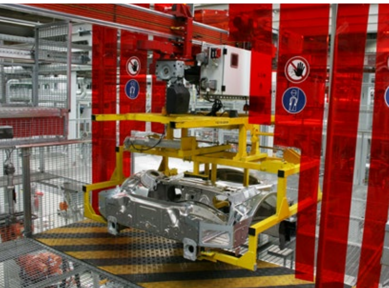
Elektrohängebahn bei VW in Osnabrück
